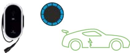
Die Ladestation ist zum Laden bereit wenn die LED-Statusanzeige konstant **blau** leuchtet. Stellen Sie sicher, dass Ihr Fahrzeug zum Laden bereit ist.
