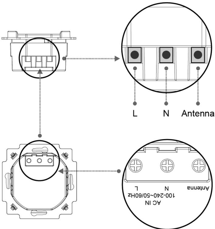
Anschließend werden beide Einheiten (Lautsprecher und Radioeinheit) in die vorhandenen Unterputz Dosen gesteckt und festgeschraubt. Achten Sie dabei, je nachdem ob die Einheiten horizontal oder vertikal verbaut werden, auf die Position der Steckkontaktleiste der Radioeinheit für die Displayeinheit.
