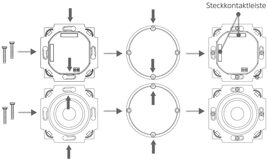
Nach erfolgter Installation der Radioeinheit und des Lautsprechers, wird der Rahmen mit Hilfe der Lautsprecherabdeckung fixiert (Abbildung 1 - 2). Stecken Sie dabei die Lautsprecherabdeckung vorsichtig mit leichtem Druck auf den Lautsprecher, bis sie einrastet.
