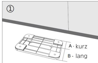
**2.** Markieren Sie die Bohrlöcher mit einem Stift
